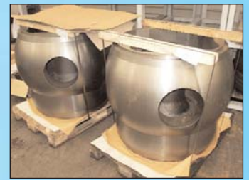
Bei GHE: Laufradschaufel vor dem Einbau. (li) Die Laufradnaben aus Stahlguss passen gerade noch auf eine Europalette. (re) Fotos: GHE
