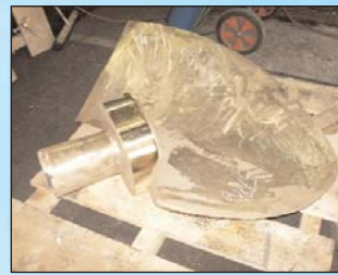
Bei GHE: Laufradschaufel vor dem Einbau. (li) Die Laufradnaben aus Stahlguss passen gerade noch auf eine Europalette. (re) Fotos: GHE
