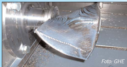
Einsatz zukunftsweisender Technologie durch Fräsen der Kaplanflügelgeometrie auf modernstem 5-achsrigem CNC gesteuerten Bearbeitungszentrum
